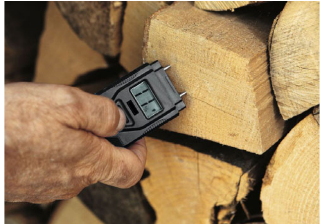
Sl. 4-3: Merilnik vlažnosti lesa
