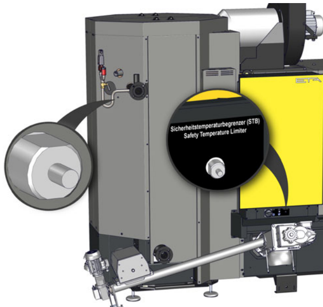
Sl. 3-3: Položaji za sprostitvev obeh varnostnih temperaturnih omejeval
