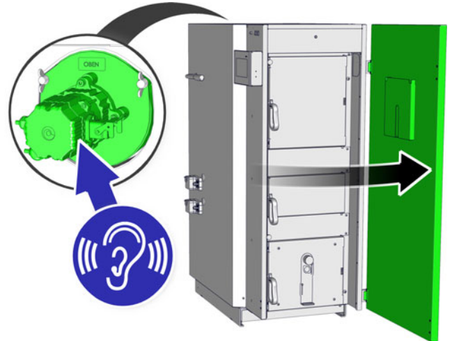
Sl. 6-2: Izolacijska vrata, ventilator za dimne pline
