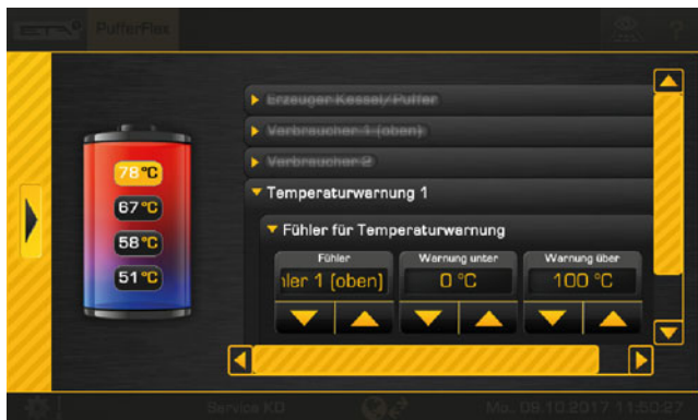
Sl. 5-81: Nastavitev temperaturnih opozoril
